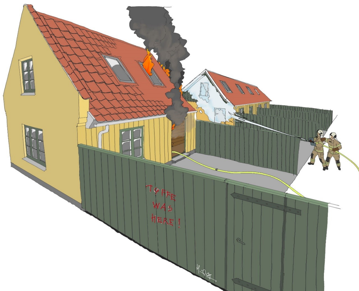
Figur 12 – Beskyttelse (begrænsning) af truet objekt med CAFS. Bygningerne på billedet er opført i træ og har tegltag. Billedet viser, at der er brand i huset til venstre og at branden er brudt gennem gavl/tag. Bygningerne er placeret så tæt, at der er risiko for antændelse af gavl på hus til højre, grundet strålevarme
