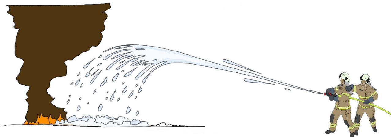
Figur 23 - Illustration af 'Rain down' påførsel af CAFS. Afstanden mellem spildet/branden og indsatsmandskabet er alene illustrativ.
