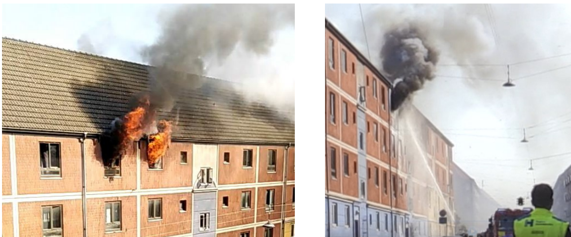
Figur 9 – CAFS Knock Down kan med fordel anvendes f.eks. ved bygninger med begrænset eller besværlig adgang, f.eks. ved nøglebokse, aflåste døre, låger og lignende. På ovenstående eksempel opnår vi den ønskede effekt allerede efter ca. 10 sekunders indsats. Stø
