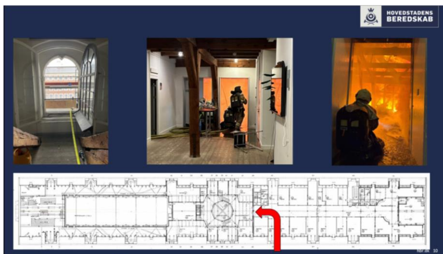
Figur 10. Specialtjenstens angreppsväg och position vid brandmuren.
